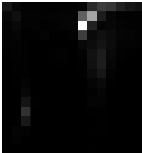
Abbildung 4.25: Gezeichnetes H-S Histogramm des in Abbildung 4.1b gezeigten Bildes. Der Farbwert ist auf der x- und die Sättigung auf der y-Achse. Die Helligkeit gibt die Anzahl des Auftretens an.
