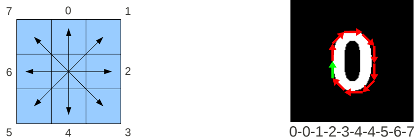
Abbildung 4.32: Richtungen und deren Codierung im Freeman Kettencode und Beispielbild mit Codierung im Freeman Kettencode beginnend ab dem grünen Pfeil.
